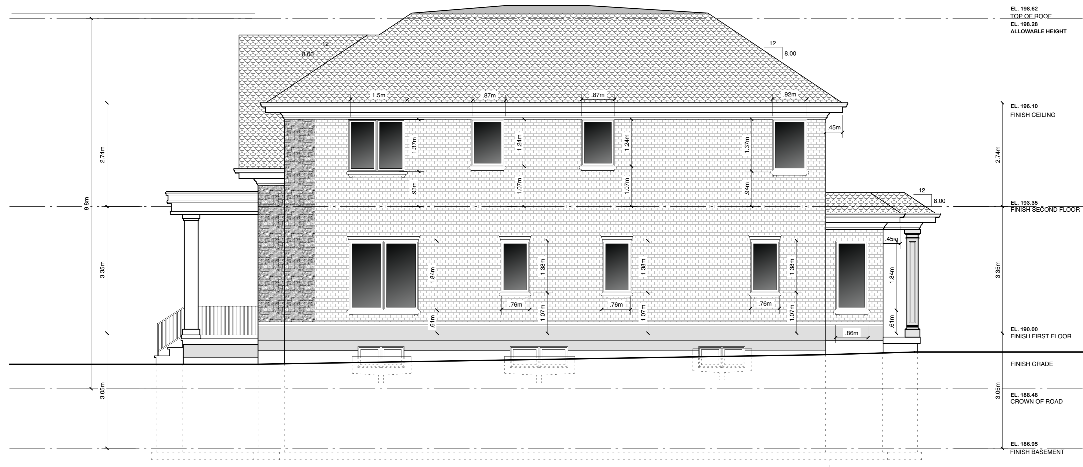
1 RIGHT SIDE ELEVATION A7 SCALE: 1:50m
